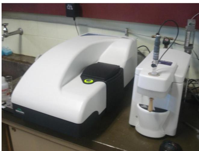
Figura 3.9: Analisador de tamanho de partícula e potencial Zeta Malvern modelo Zetasizer Nano ZS90 (DF-UFPE).
