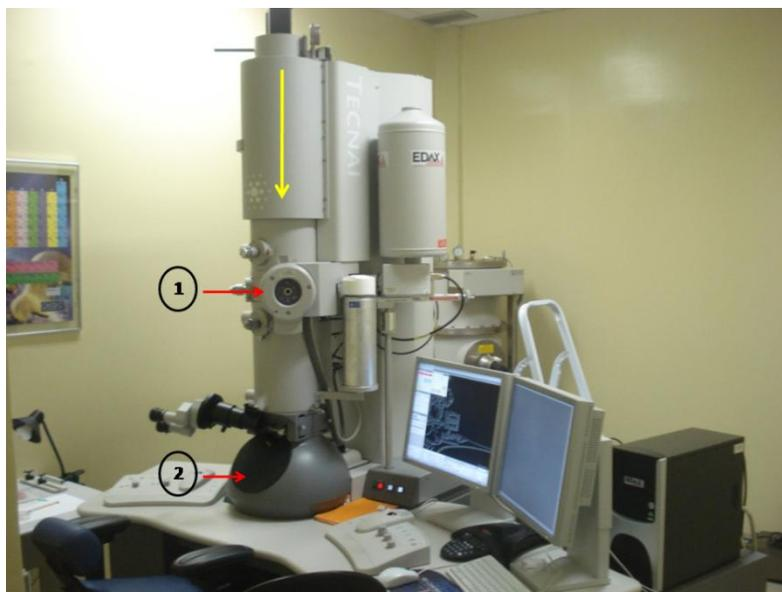
Figura 3.6: Microscópio eletrônico de transmissão Tecnai G<sup>2</sup> Spirit. A seta amarela na coluna vertical indica a direção do feixe de elétrons que incide sobre a amostra em 1. Em 2, a chapa fotográfica para visualização das imagens (CETENE).
