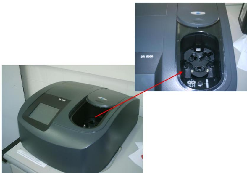
Figura 3.14: Espectrofotômetro Hach DR 5000 UV-vis. Em destaque, o local de deposição da cubeta contendo a amostra (LQ-IPCM-UNIVASF).
