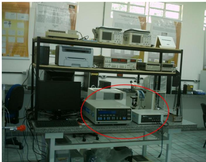
Figura 3.4: Em destaque: à esquerda, o analisador de impedância SI 1260 e à direita, a interface dielétrica SI 1296 (LEIMO 1).
