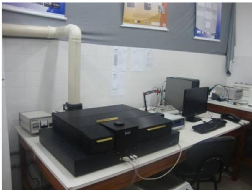
Figura 2.12 - Espectrofluorímetro ISS-PC1
