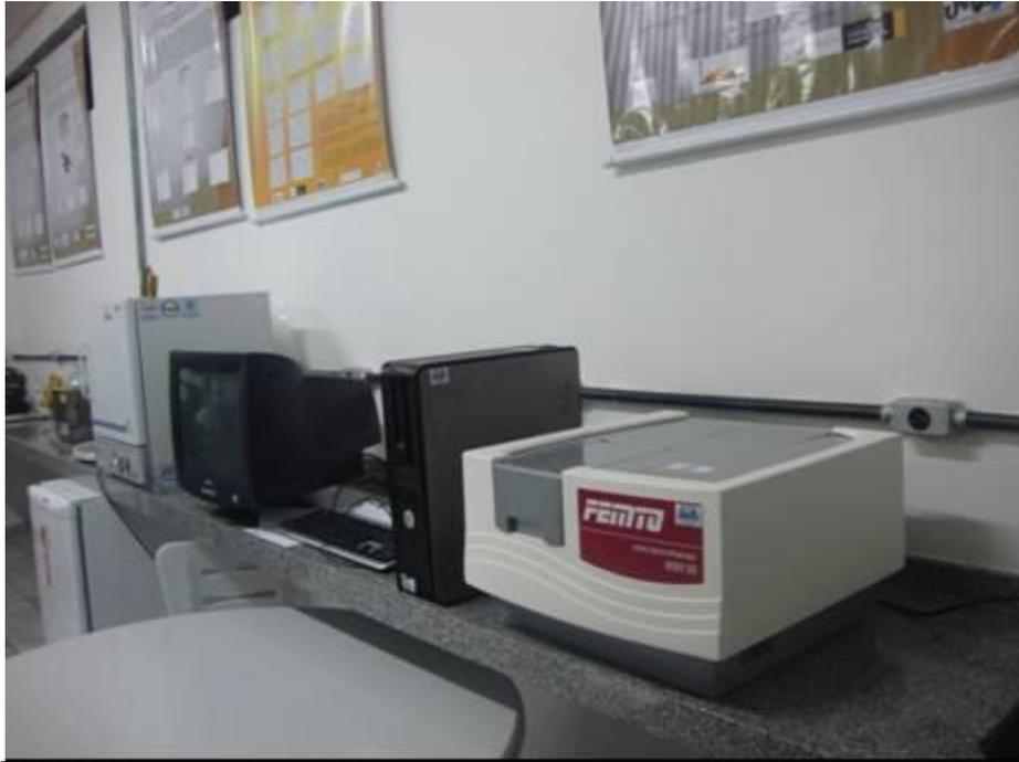
Figura 2.15 - Espectrofotômetro de UV-visível usado nos experimentos
