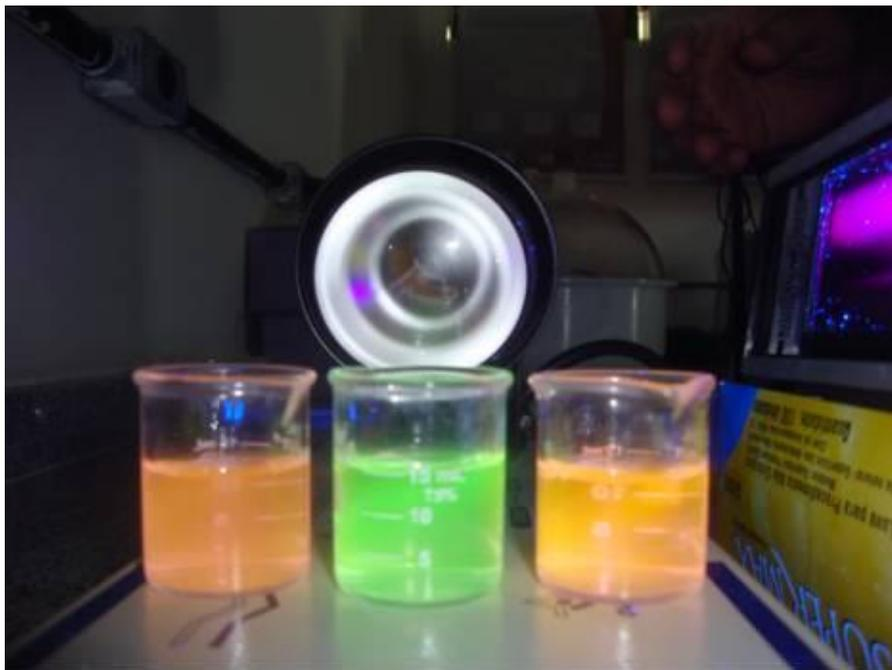
*Figura 2.2 - Aparato experimental para exposição direta das rodaminas à luz branca (frontal) e luz na região do ultra-violeta (365 nm) disposta lateralmente à montagem.*
