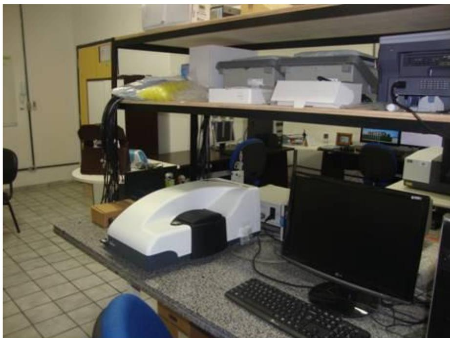
*Figura 2.7 - Medidor de tamanho de partículas e potencial zeta – Zeta Sizer Malvern*
