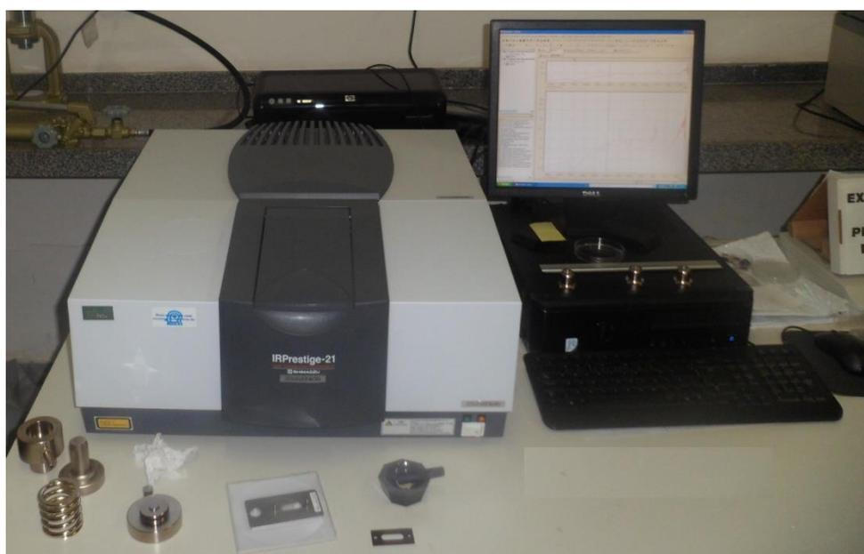
Figura 21: Espectrômetro de Infravermelho de Transformada de Fourie.
