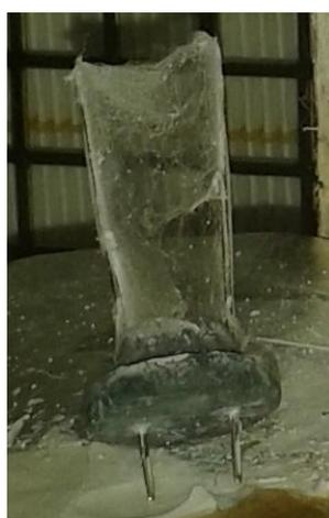
Figura 25: Coletor contendo fibras de PVP/ZnO
