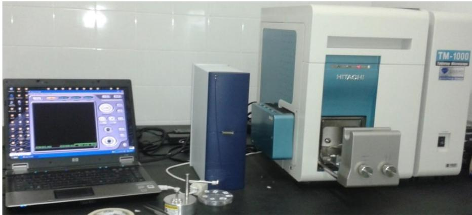
**Figura 6.2:** Microscópio eletrônico de varredura (MEV) da marca HITACHI, modelo TM 1000
