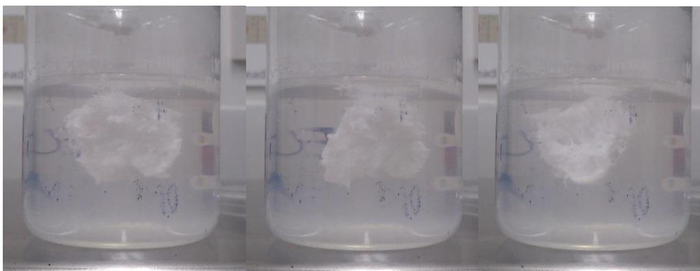
**Figura 4.1:** Imagens do sistema Eudragit® L100 solubilizados em metanol e adicionado na solução acidificada HCl (0,5 M pH=2)
