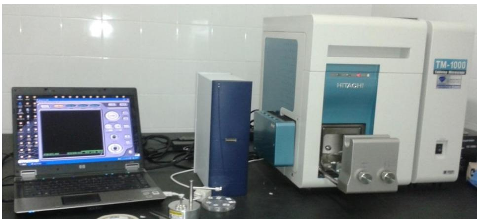
**Figura 3.7:** Microscópio eletrônico de varredura (MEV) da marca HITACHI, modelo TM 1000
