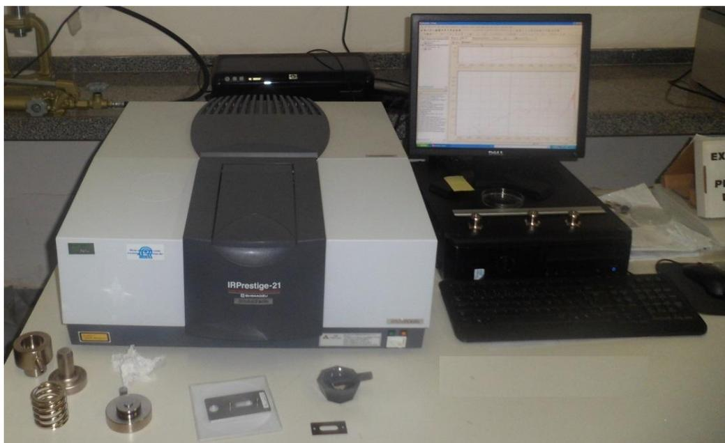
**Figura 3.8:** Espectro de Infravermelho por Transformada de Fourier (FTIR) da marca SHIMADZU, modelo IR PRESTIGE - 21
