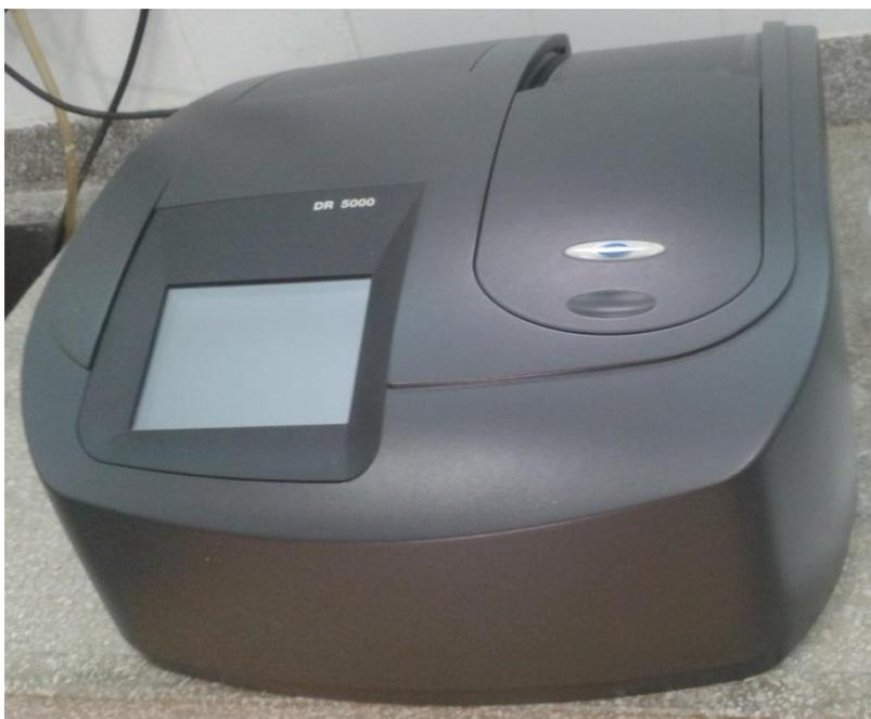
**Figura 3.5:** Espectrofotômetro (UV-Vis) marca HACH, modelo DR 500
